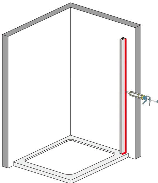
Mettez un joint en silicone à l'extérieur de la porte de douche (entre le profilé mural et le mur et entre le cadre/la baguette et le receveur). Pas de douche dans les 24h après le montage
