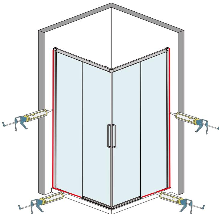
Mettez la silicone à l'extérieur de la porte de douche ( entre le profilé mural et le mur et entre le cadre/la baguette et le receveur ).
