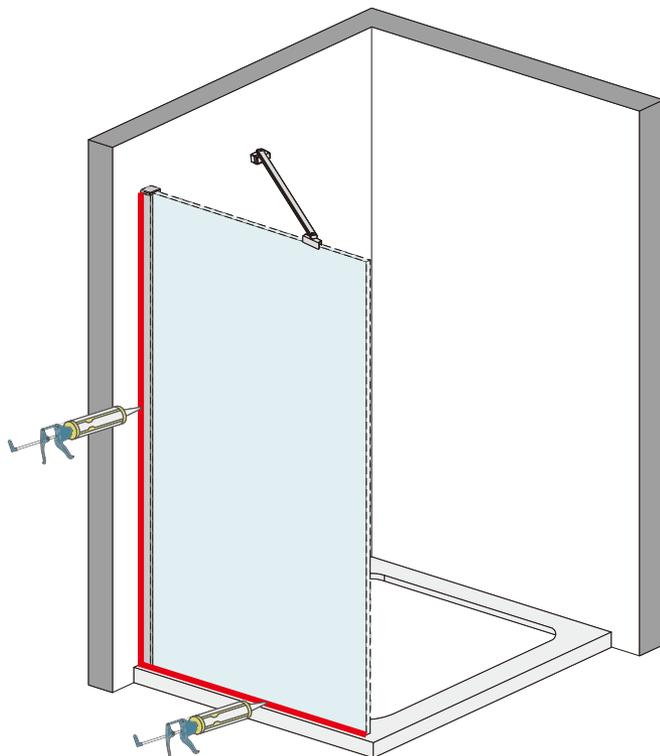
Mettez la silicone à l'extérieur de la porte de douche ( entre le profilé mural et le mur et entre le cadre/la baguette et le receveur ).
