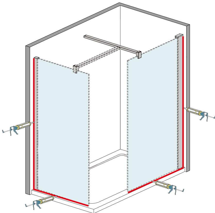
Mettez un joint en silicone à l'extérieur de la porte de douche (entre le profilé mural et le mur et entre le cadre/la baguette et le receveur). Pas de douche dans les 24h après le montage
