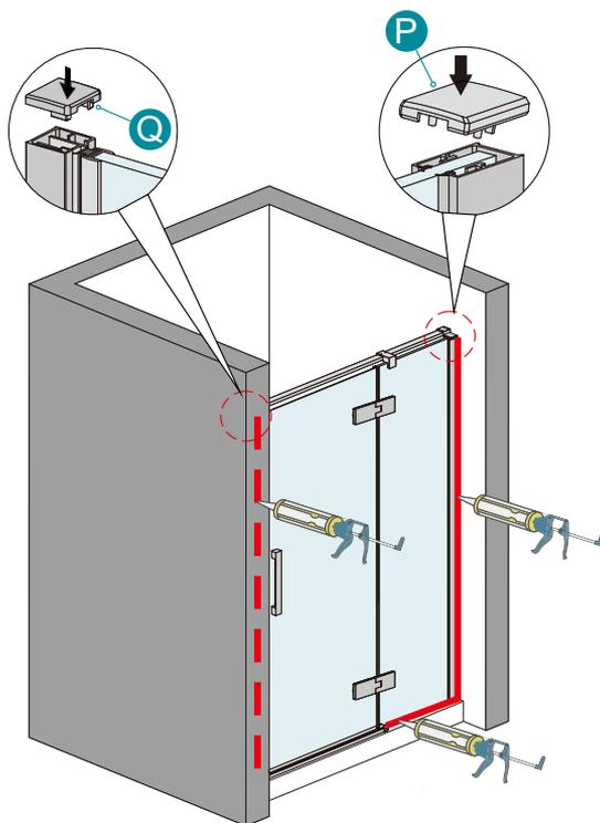
Mettez la silicone à l'extérieur de la porte de douche ( entre le profilé mural et le mur et entre le cadre/la baguette et le receveur ). Pas de douche dans 24h après le montage.
