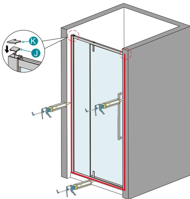
Mettez la silicone à l'extérieur de la porte de douche ( entre le profilé mural et le mur et entre le cadre/la baguette et le receveur ).
