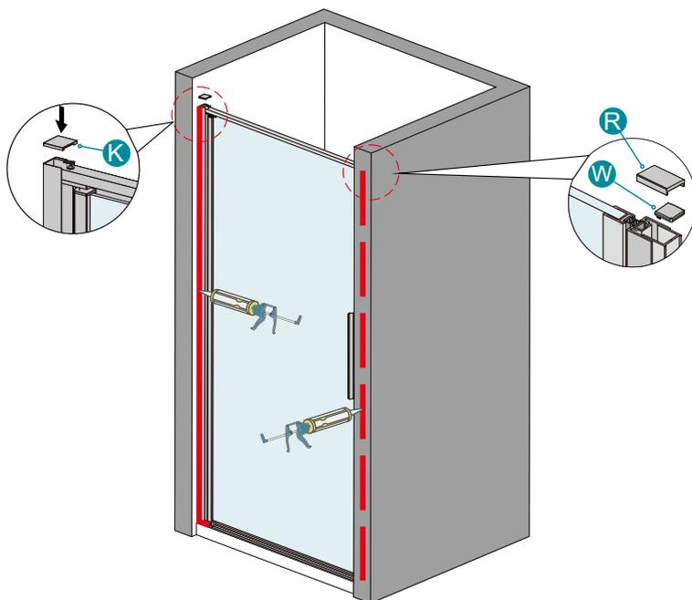
Mettez la silicone à l'extérieur de la porte de douche ( entre le profilé mural et le mur et entre le cadre/la baguette et le receveur ).
