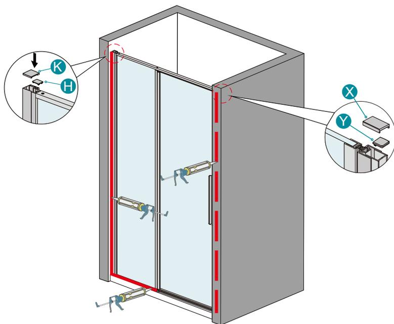
Mettez la silicone à l'extérieur de la porte de douche ( entre le profilé mural et le mur et entre le cadre/la baguette et le receveur ). Pas de douche dans 24h après le montage.
