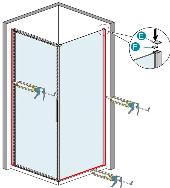
Mettez la silicone à l'extérieur de la porte de douche ( entre le profilé mural et le mur et entre le cadre/la baguette et le receveur ).
