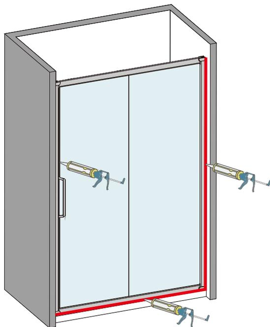
Mettez la silicone à l'extérieur de la porte de douche ( entre le profilé mural et le mur et entre le cadre/la baguette et le receveur ). Pas de douche dans 24h après le montage.
