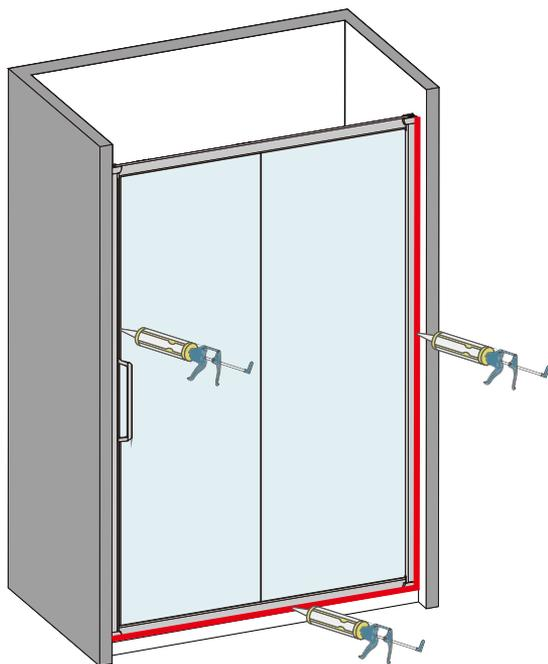
Mettez un joint en silicone à l'extérieur de la porte de douche (entre le profilé mural et le mur et entre le cadre/la baguette et le receveur). Pas de douche dans les 24h après le montage
