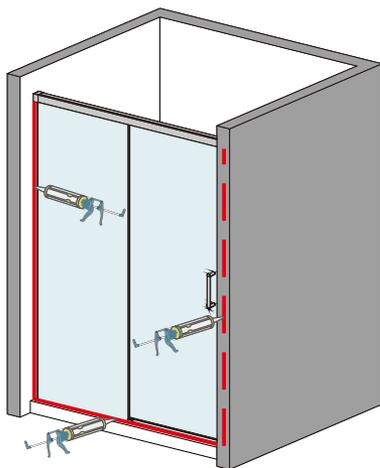
Mettez la silicone à l'extérieur de la porte de douche ( entre le profilé mural et le mur et entre le cadre/la baguette et le receveur ).
