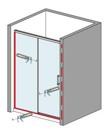
Mettez la silicone à l'extérieur de la porte de douche ( entre le profilé mural et le mur et entre le cadre/la baguette et le receveur ). Pas de douche dans 24h aprés le montage.
