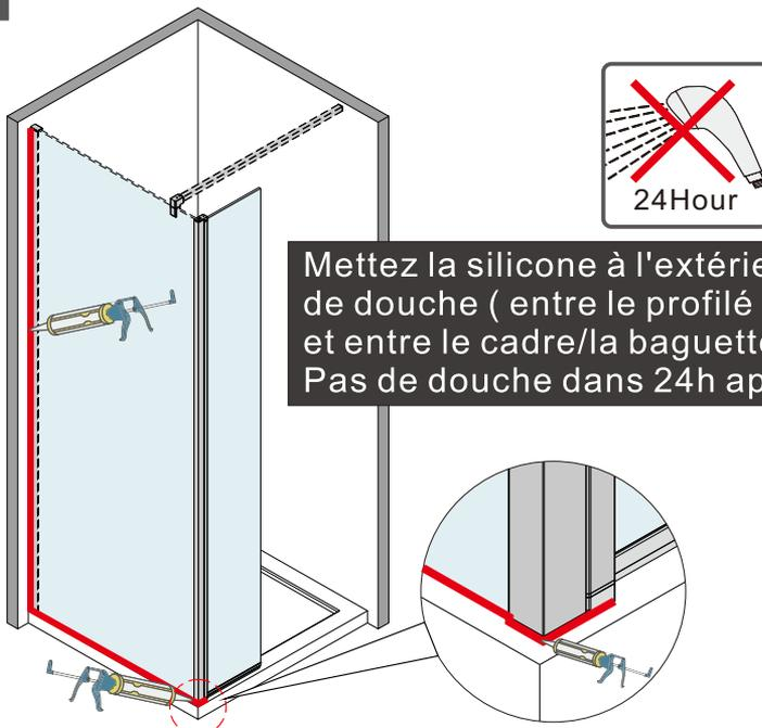
Mettez la silicone à l'extérieur de la porte de douche ( entre le profilé mural et le mur et entre le cadre/la baguette et le receveur ). Pas de douche dans 24h après le montage.
