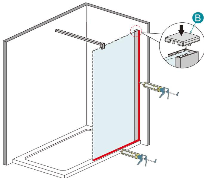
Mettez la silicone à l'extérieur de la porte de douche ( entre le profilé mural et le mur et entre le cadre/la baguette et le receveur ). Pas de douche dans 24h après le montage.
