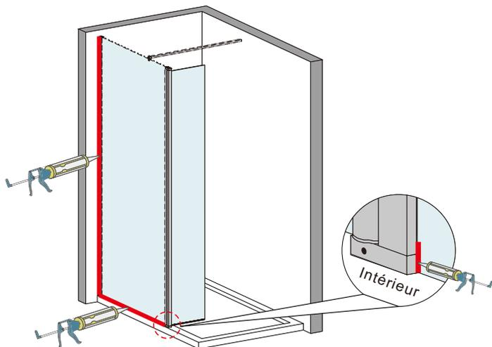
Mettez la silicone à l'extérieur de la porte de douche ( entre le profilé mural et le mur et entre le cadre/la baguette et le receveur ). Pas de douche dans 24h après le montage.
