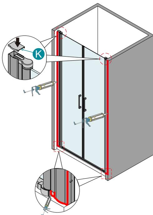
Mettez la silicone à l'extérieur de la porte de douche ( entre le profilé mural et le mur et entre le cadre/la baguette et le receveur ).
