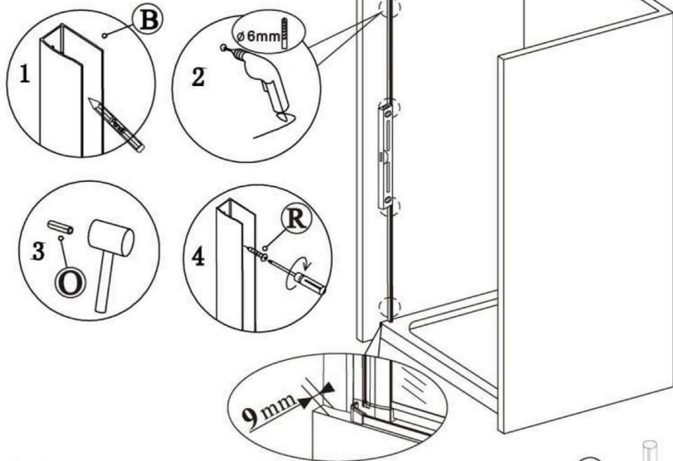
Il existe un espace de 9mm entre le mur et le profilé mural pour poser la jointure d'étanchéité
